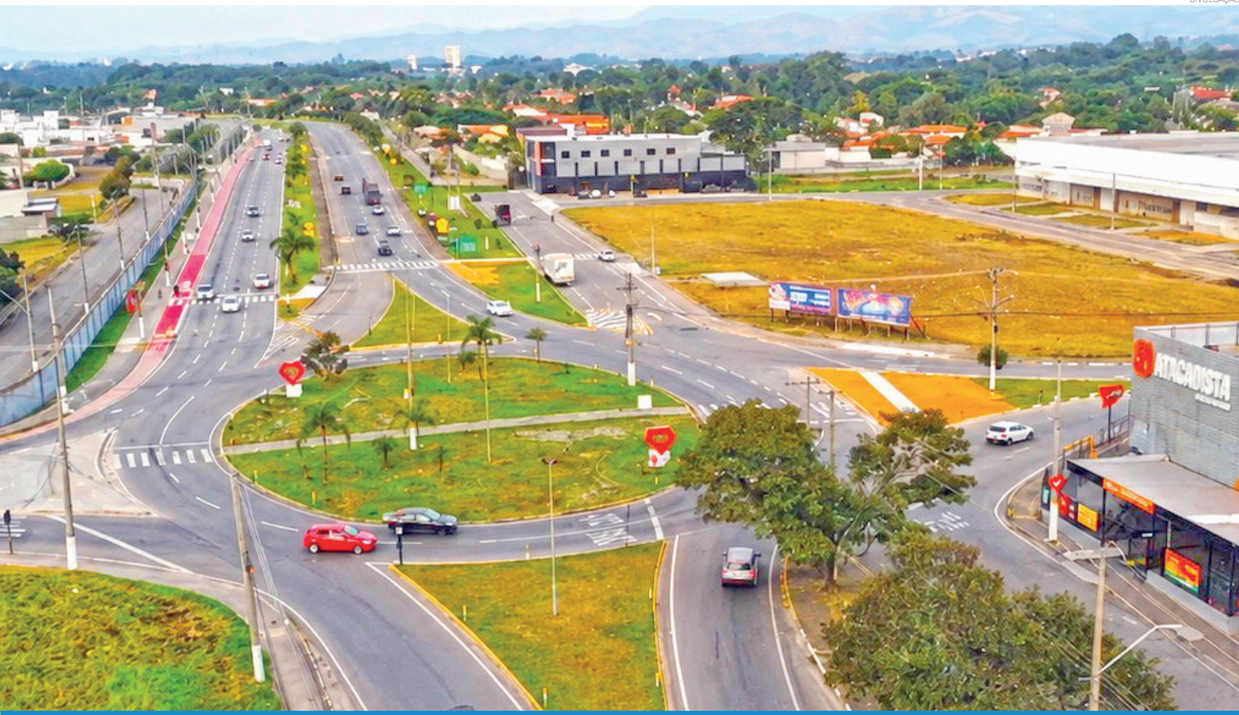
Atualmente, o local apresenta uma configuração atípica e perigosa: faixas de pedestres que cortam o centro da rotatória
