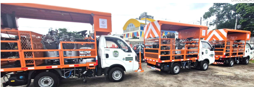
Braços ambidestros dos caminhões permitirão que façam, simultaneamente, pinturas de vários modelos de sinalização no centro e nas laterais das ruas
