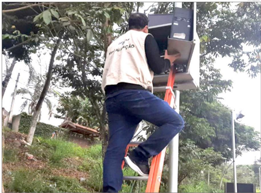
**Objetivo é verificar se a leitura dos radares está em conformidade com a velocidade permitida na via pública, bem como se a velocidade que o radar marca dos veículos está correta e de acordo com a legislação**
