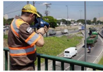
É o Radar Trucam, um equipamento eletrônico móvel com sensor a laser. Em formato de um revólver, o equipamento identifica imagens de até três tipos de veículos — motos, carros, ônibus e caminhões — por segundo. Formado por mira a laser, medidor de velocidade, câmera de vídeo digital e gravador de imagens, o radar tem capacidade de fazer até 30 autuações por minuto. Desde que adotou
